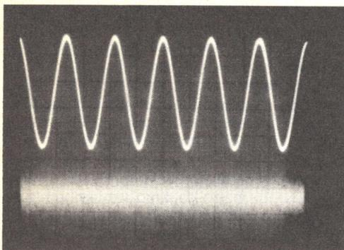
*Fig. 9 - L'analisi spettrale dell'uscita a basso livello dell'amplificatore mostra che ogni prodotto di distorsione armonica è così basso da risultare mascherato dal tappeto di "erbetta" prodotto dal rumore.*
