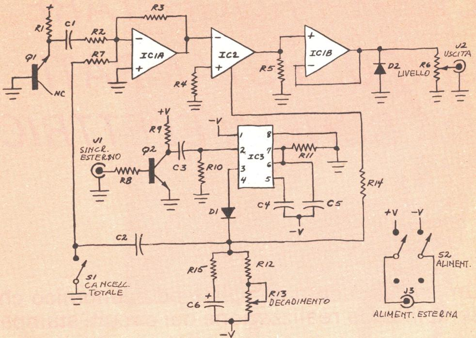
Fig. 1 - Esempio di circuito per il quale si vuole realizzare il circuito stampato. Si veda l'inserto "Come funziona" per quanto riguarda i dettagli circuitali.
