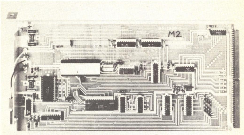
*Questa fotografia e quella qui a fianco mostrano la differenza tra una piastra su cui è montata l'unità centrale di elaborazione (CPU) a 8 bit usata nell'elaboratore H8 della Heath (qui sopra) ed una piastra per elaboratore a 16 bit.*
