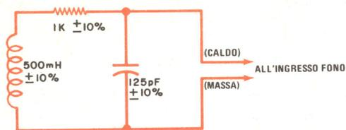
Fig. 4 - Schema elettrico del circuito da collegare agli ingressi fono per cartuccia a magnete mobile del preamplificatore per eseguire le misure di rumore.
