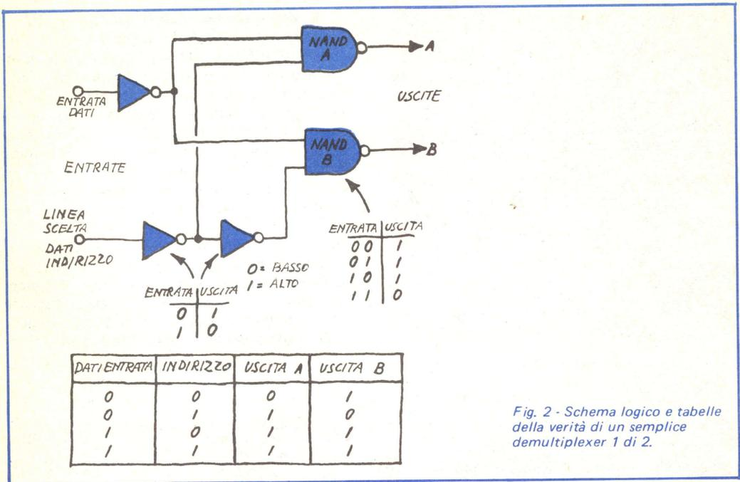
Fig. 2 - Schema logico e tabelle della verità di un semplice demultiplexer 1 di 2.
