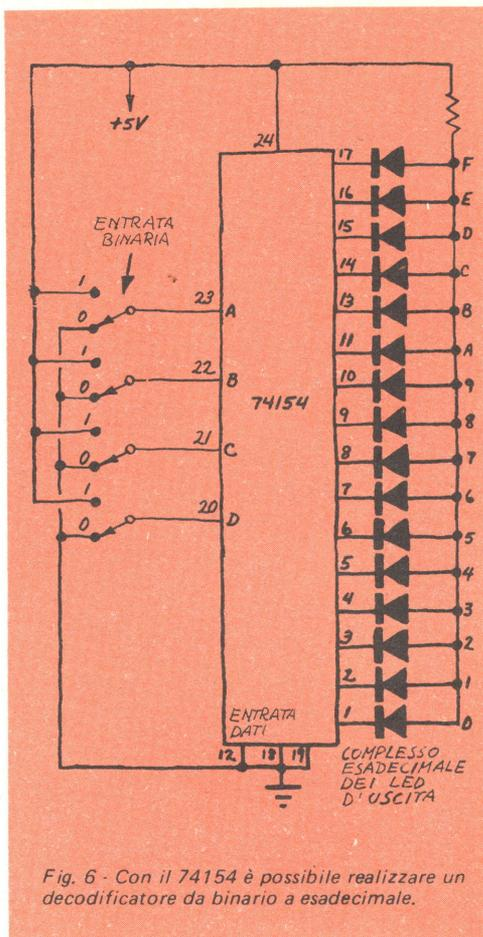
*Fig. 6* - Con il 74154 è possibile realizzare un decodificatore da binario a esadecimale.
