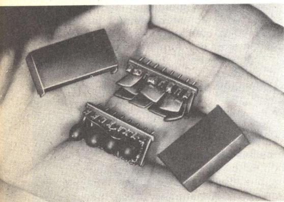
*Fig. 1* - Due moltiplicatori in contenitori del tipo dual-in-line.
