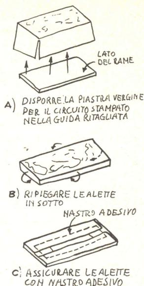
Fig. 5 - Sono qui illustrate le tre fasi del lavoro finale: in A) si ricopre la bassetta vergine per circuito stampato con la guida ritagliata, in B) si ripiegano le alette in sotto, fissando poi il tutto con nastro adesivo (C).
