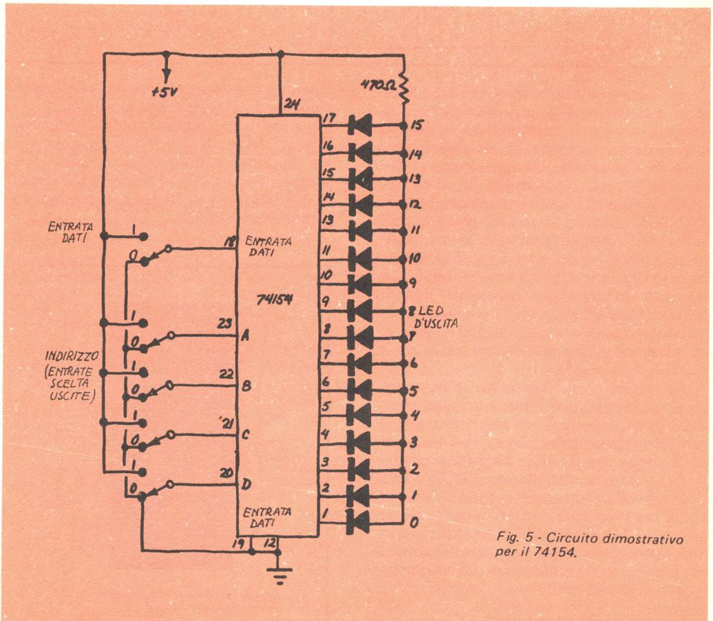
Fig. 5 - Circuito dimostrativo per il 74154.
