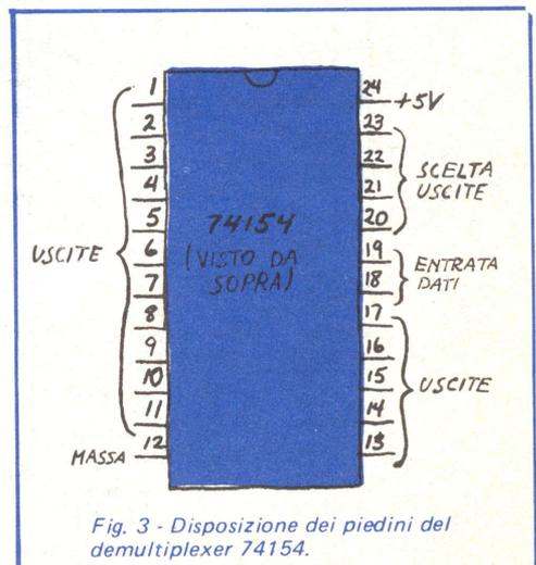
Fig. 3 - Disposizione dei piedini del demultiplexer 74154.
