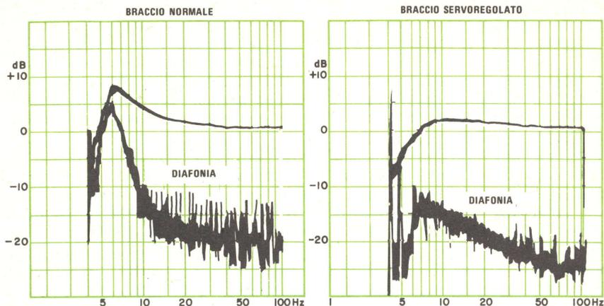
Fig. 2 - L'azione smorzante del sistema elettronico della Sony riduce sensibilmente l'ampiezza della risonanza fondamentale del sistema braccio-testina e la diafonia tra i canali.
