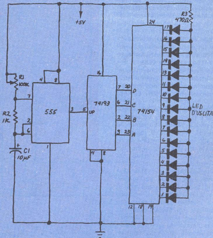
Fig. 7 - Circuito sequenziatore 1 di 16.
